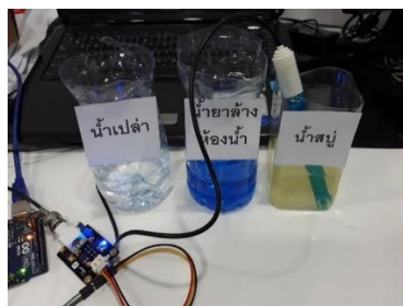
รูปภาพที่ 2.48 ตัวอย่างการใช้งานเซนเซอร์วัดค่า PH
